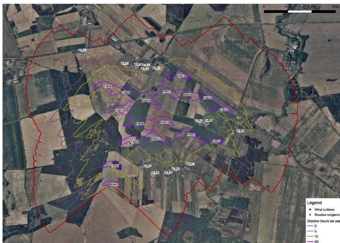
Rysunek 7. Wyniki obliczeń efektu migotania cienia (Legenda : * Turbiny Wiatrowe, • Zacienione objekty; - Zacienienie (godziny/rok) : czerwona linia – 0, niebieska linia -5; zielona linia – 10; fioletowa linia – 50).
